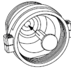
Abb. 2: Adapter M28 x 1,5 mm inkl. Stift (im Lieferumfang beim Heizkörperthermostat enthalten)
