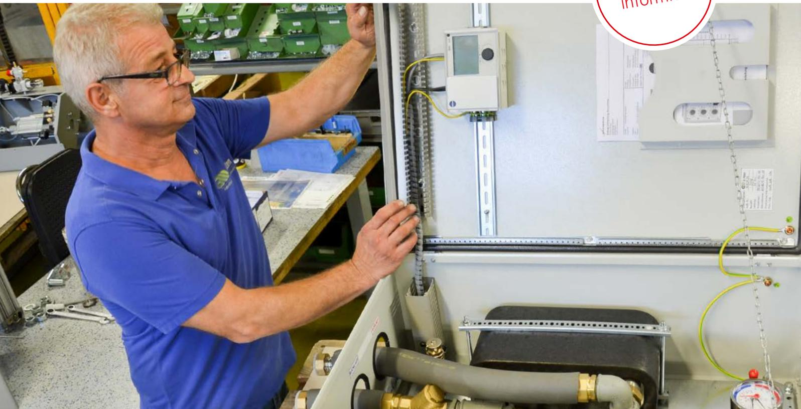
Rund 30 Mitarbeiterinnen und Mitarbeiter aus verschiedenen Abteilungen sind an der Fertigung beteiligt, unter anderem aus der Elektrobearbeitung, Metallbearbeitung, Montage und dem Schilderdruck. Der Zusammenbau der Fernwärme-Übergabestationen samt anschließender Druckprüfung erfolgt durch drei speziell geschulte Fachkräfte. Auch die Qualitätssicherung findet direkt im Haus statt.
